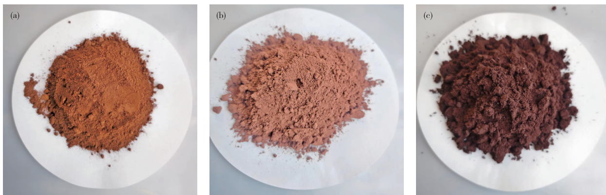
(a)液固比6.7、转化温度196℃、转化时间1.5h;(b)液固比6.7、转化温度198℃、转化时间1.5h; (c)液固比6.5、转化温度209.8℃、转化时间1.5h
